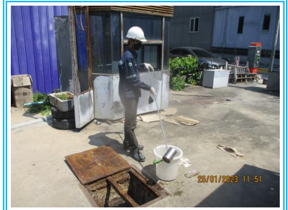
หลังจากออกจากบ่อบำบัดน้ำเสียขนาด 52 ลบ.ม
